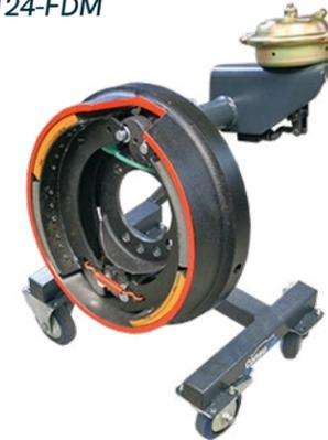
**Disque pneumatique avec frein à ressort pour HV-125**
